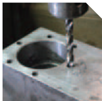
1. Fura a rosca danificada utilizando a broca com o tamanho correto
