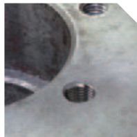
6. A rosca está reparada e pronta a utilizar
