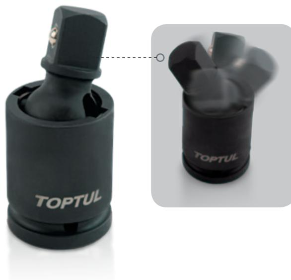
• O novo cardan universal de impacto da TOPTUL atinge 360 graus de rotação a um ângulo de até 30 graus a partir da vertical. O mecanismo articulado está concebido com o pino de bloqueio dentro da parede da chave para força, durabilidade e segurança elevadas.
